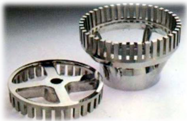
Slika 109. Rotor i stator miksera s turbinama (Krell, 1996).
